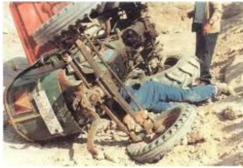
Figura 3 – Ausência de Estruturas de Proteção ao Capotamento, risco iminente de esmagamento do Operador.
