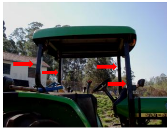
Figura 1 –Estruturas de Proteção ao Capotamento (EPC)
