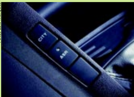
A posição “city”, no Fiat Stilo Abarth facilita o giro da direção, para ser usado em cidades
