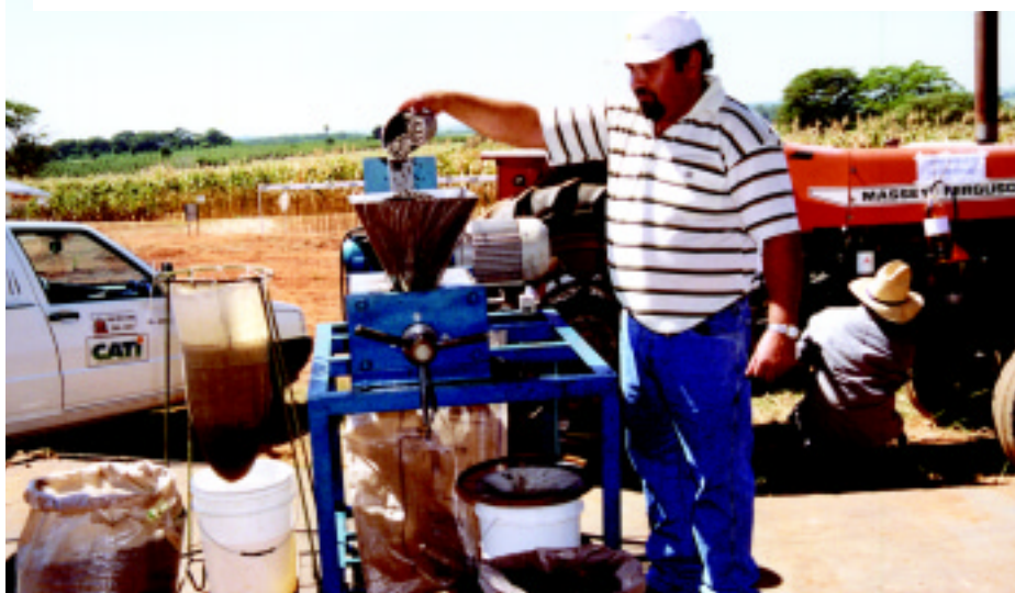
Prensas com operação simplificada podem processar de 40 a 300 Kg de girassol/ hora
